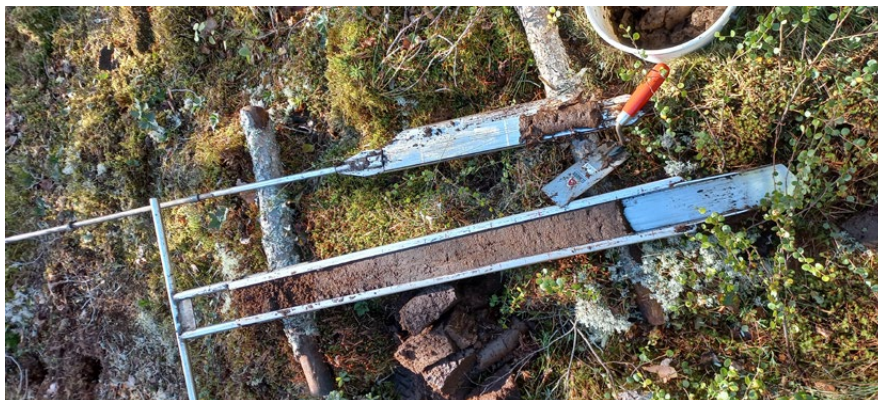
Kuva 3. Näytteenotossa käytettiin laippakairaa (ylempi kaira) sekä laatikkokairaa (alempi kaira). Kuva: Joni Palola, GTK.
